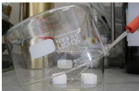
Abbildung 51: Becherglas, das mit einem größeren Becherglas abgedeckt ist, mit Teflonhaltern und Argonzufuhr.
