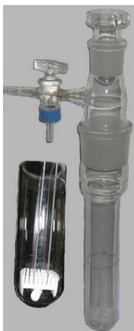
Abbildung 50: Schlenk-Gefäß und Teflonhalter zur Funktionalisierung von Oberflächen
