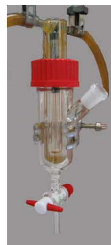
Abbildung 52: Festphasenreaktor mit Kühlvorrichtung und UV-Lampe.
