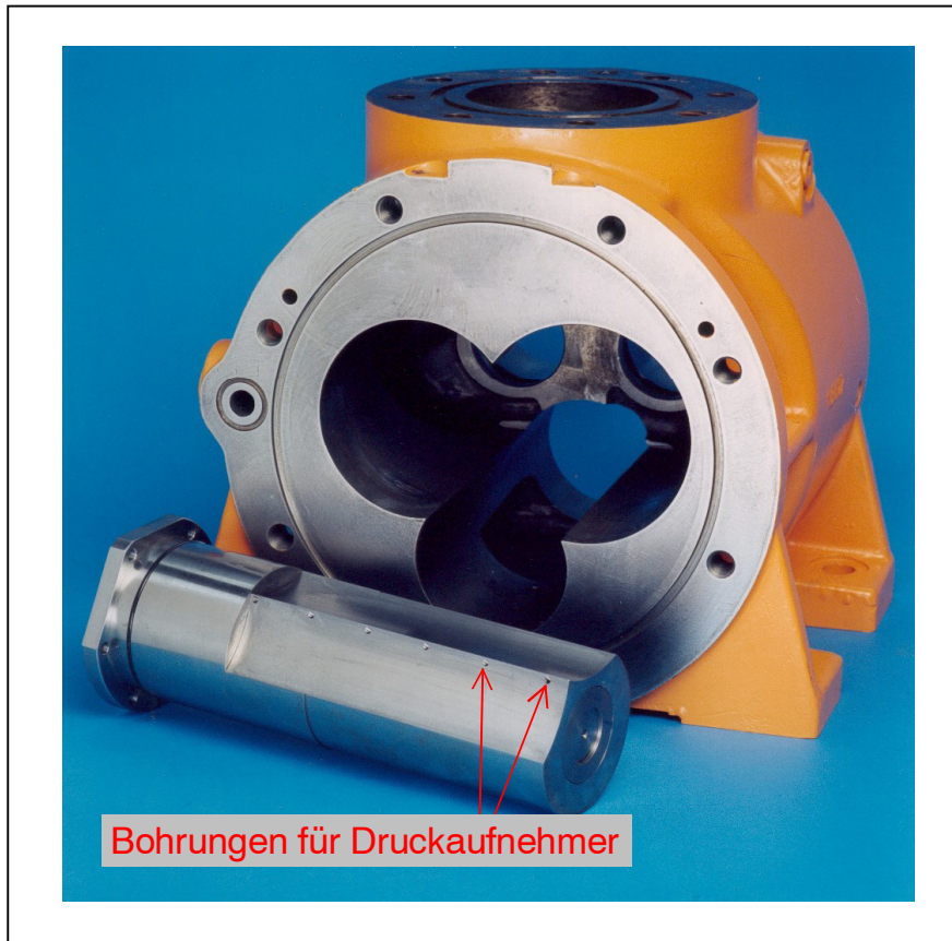
Bild 5.17: Gehäuse der Versuchsmaschine und Einsatz mit Verschneidungskante und Bohrungen für die Druckaufnehmer
