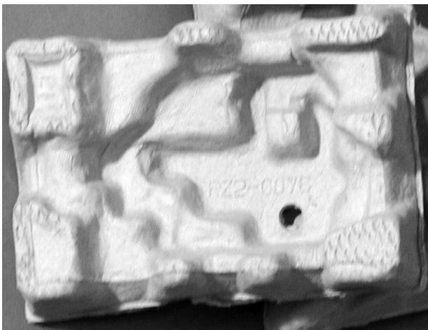
Bild 2.7: Siebseite eines Faserformproduktes und vergrößerte Darstellung der Struktur /WIL02/
