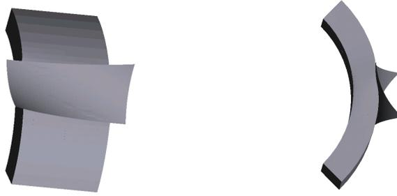
**Abb. II.9:** Kontaktscheibenbelag in Kontakt mit dem Werkstück bei einer Zustellung von  $d := -0.05$  dm.
