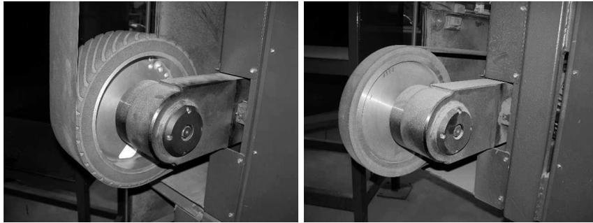
**Abb. II.6:** Kontaktscheibe mit Nutungen im Kontaktscheibenbelag, Kontaktscheibe mit profillosem Kontaktscheibenbelag.
