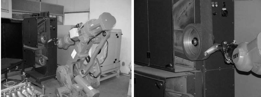
Abb. II.3: Roboterarm mit Werkstück (Sanitärarmatur), Bandschleifgerät.
