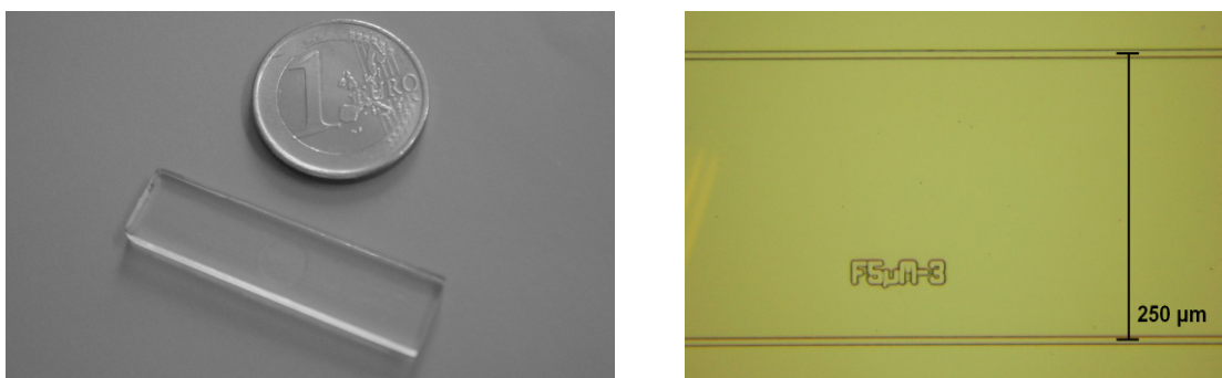
Bild 4.7: Links: Heißgeprägter TPX-Chip (4 x 1 cm 2 ). Rechts: Oberfläche des Chips.
