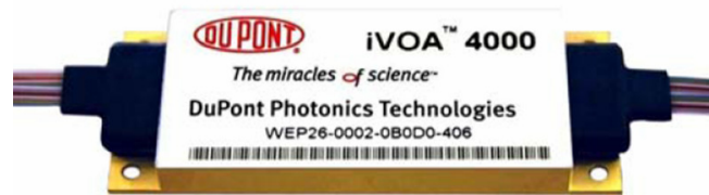
Bild 3.25: iVOA von DuPont auf Polymer-PLC-Basis. Erhältlich seit Februar 2006 [94].
