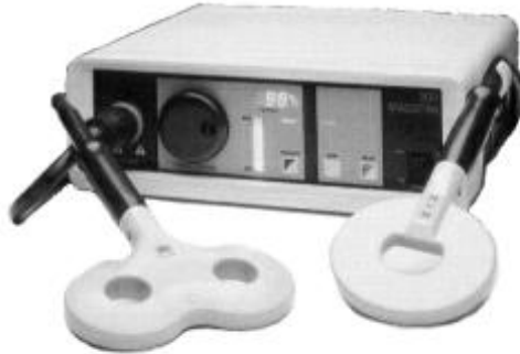
Abbildung 6.3: Foto eines kommerziellen TMS-Gerätes mit zugehörigen TMS-Spulen (Ring- und “Schmetterlings”-Spule).
