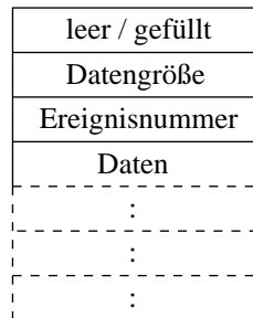
Abbildung A.6: Aufbau eines Ringspeicherblocks. Durch Überschreiben der ersten Speicherstelle wird der R/O-Mutterkarte die Vollständigkeit der Daten mitgeteilt. Darüberhinaus benötigt diese die Größe der zu übertragenden Daten und die assoziierte Ereignisnummer. Daran schließen sich die eigentlichen Daten an.
