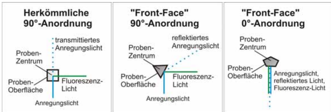
Abbildung 4: Verschiedene Geometrien zur Fluoreszenzdetektion
