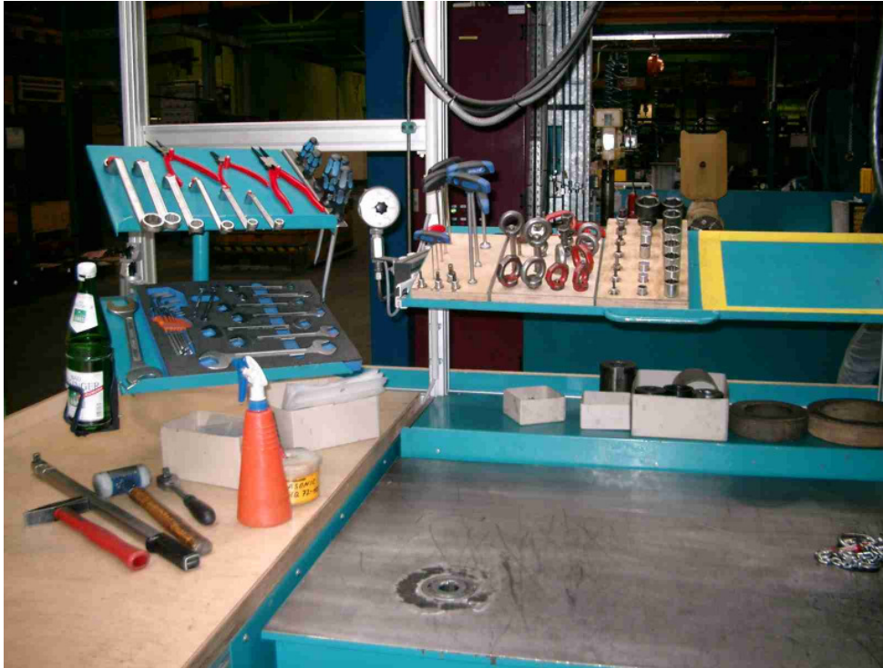
Abb. 7.5: Werkzeuganordnung in einem geplanten (und nach Abschluss der Montageplanung realisierten) Mikro-Arbeitssystem
