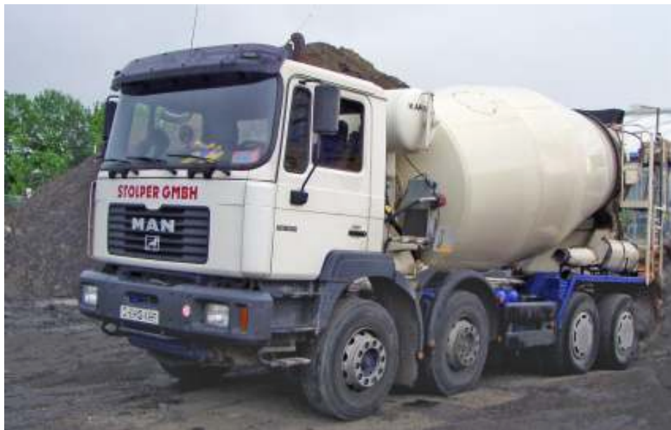
Abbildung 3.7: Spezialfahrzeug für Transportbeton
