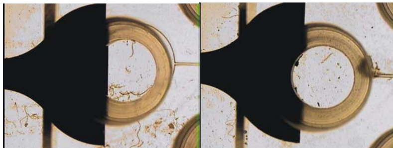
Abb.60: Foto der Leistungselektroden zweier Platin-CE-Mikrochips: links vor Benutzung, rechts nach mehreren Analysen
