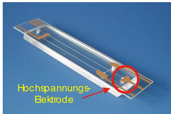
Abb.59: Photo eines CE-Mikrochips mit Dünnschichtelektroden als Leistungselektroden für die Hochspannungsversorgung
