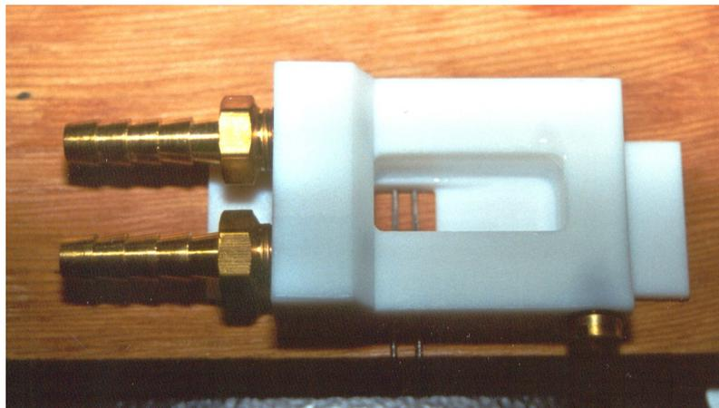
**Abbildung 4.9** Darstellung der zur Bildung der GUV verwendeten Kammer.
