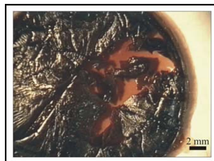
Abbildung 183: Vergrößerte Darstellung einer Polymer/Magnetitschicht. Verwendet wurde die Probe B, eine Konzentration des Monomers (OTCIS) von 0,1 mmol/L und eine Ammoniak Konzentration von ca. 3600 ppm.
