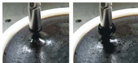
Abbildung 196: Bruch der Schicht und Anspringen der magnetischen Probe an den Dauermagneten
