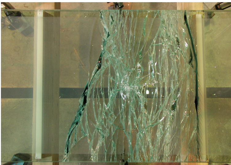
Bild 88: Bruchbild für liniengelagerte HOE-Gläser
