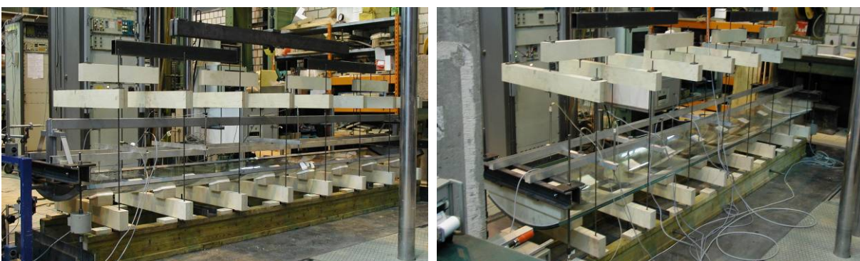
Bild 119: Versuchstand a) Lamelle komplett mit Stahlkonstruktion, b) nur gebogene VG-Scheibe
