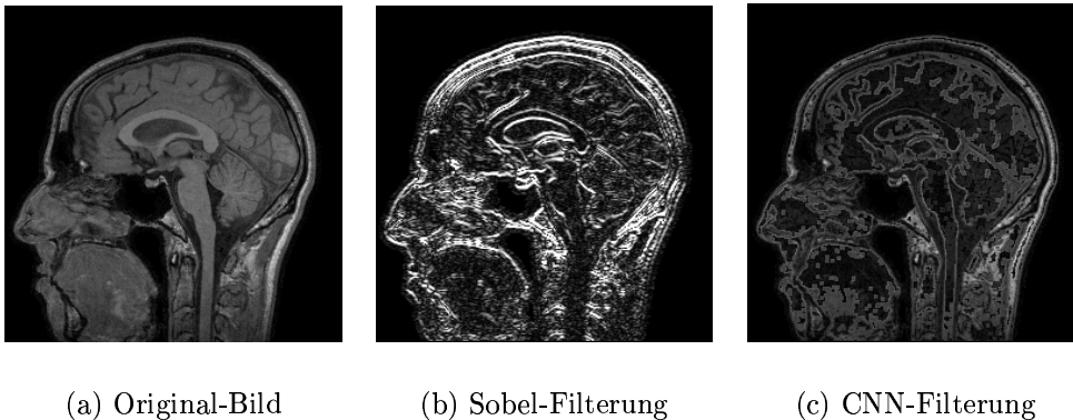
Abbildung 4.3: Anwendung von CNN für die Hervorhebung von Kanten im Vergleich zum Sobel-Filter.
