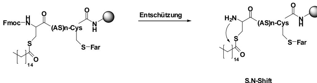
Abbildung 46 : S,N-Shift nach der Entschützung. Nach Entfernen der Fmoc-Gruppe greift das Amin den Thioester an und es kommt so einem Acylshift.
