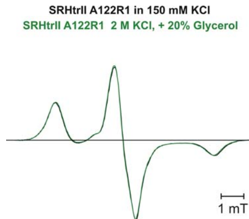
Abb. 3.2.5: TT-ESR-Spektrum von HtrIIA122R1 in Abhängigkeit von der Salzkonzentration. Das Spektrum in Schwarz dargestellt wurde bei 150 mM KCl und das in Grün bei 2 M KCl unter Zugabe von 20 % Glycerol aufgenommen.
