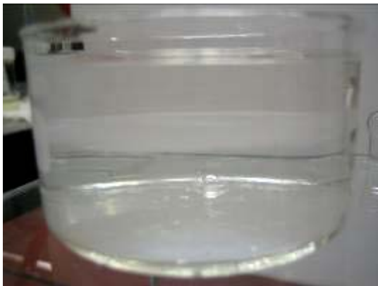
Abbildung 93: Geschlossener \text{CaCO}_3 /Stearinsäure-Film an der Öl-Wasser-Grenzfläche (Bildmitte).
