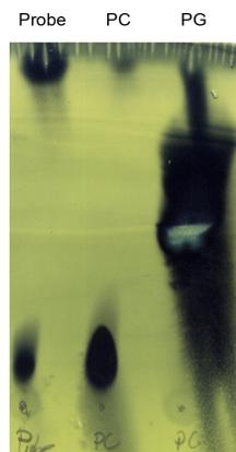
**Abbildung 34:** DC des ausgefallenen Fluoreszenzansatzes (Ansatz 3); Laufmittel Chloroform:Methanol 1:1; Färbung der Lipide mit Phosphomolybdat; v.l.n.r.: Probe, DOPC (rein), DOPG (rein). Es kann davon ausgegangen werden, dass die höhere Bande bei der Probe DOPG entspricht, da nur DOPC und DOPG in den Liposomen enthalten war. Die Spur in der reinen DOPG aufgetragen ist, ist überladen.
