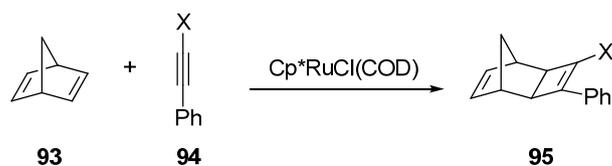
**Schema 22:** Cp\*Ru-katalysierte [2+2]-Zykloaddition.
