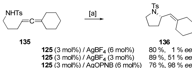
Abbildung 45. Enantioselective intramolekulare Hydroaminierung von Allenen. Reagenzien und Bedingungen: [a] DCE, 23 °C.
