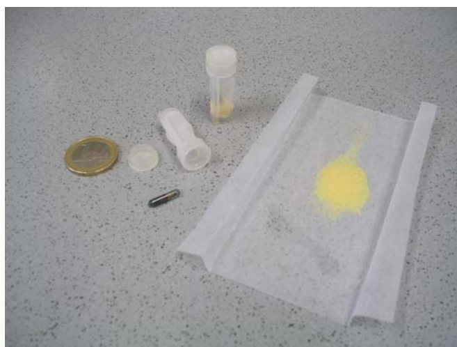
Abbildung 25 IRORI MacroKan™, Deckel, RFID-tag und 250 mg Harz.
