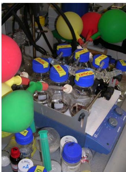
Abbildung 56 Apparativer Aufbau zur kombinatorischen Festphasensynthese.
