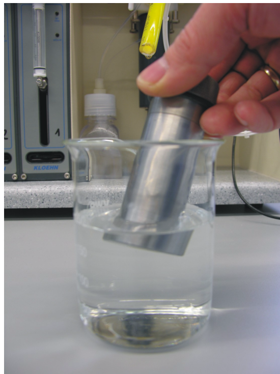
Abbildung 3.12: Links: Schematischer Querschnitt durch die Zetapotenzial Messeinheit des DT-1200 [24] . Rechts: Bild der Sonde.
