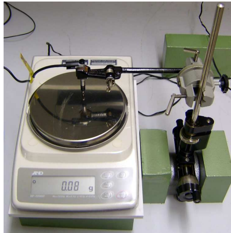
Abbildung 6.14: Messaufbau zur Bestimmung der Kraft, die der Messtaster auf eine Waage ausübt
