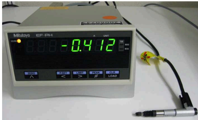
Abbildung 6.13: Photographie des Messtasters „Linear Gage Slim Head“ und der Ausleseeinheit „Linear Gage EF Counter“ der Firma Mitutoyo
