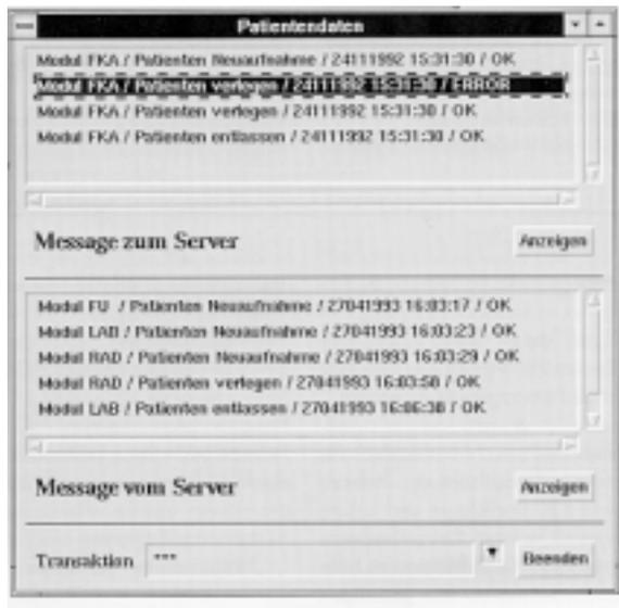
**Abbildung 6.16:** Darstellung der Benutzeroberfläche des System-Monitors des HL7-CONNECTION-SERVER<sup>TM</sup>. Eine graphische Darstellung der Kommunikationsverbindungen ist nicht möglich. Angezeigt werden lediglich die über den Kommunikationsserver ausgetauschten Nachrichten. Die Abbildung wurde aus [pro95] entnommen.
