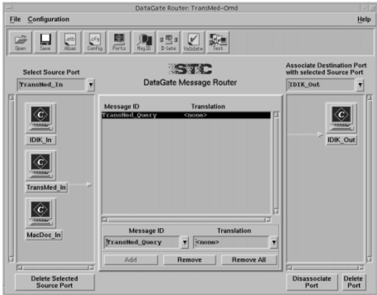
**Abbildung 7.7:** Graphische Darstellung der Routing-Tabelle in DATA GATE™ für die Abfrage der Stammdaten im PDV-System.
