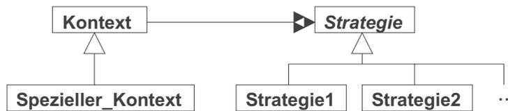
Abbildung 5.3: In bestimmten Situationen kann es notwendig sein, eine geerbte Delegationsbeziehung aufzulösen. Dazu bietet E+ die `undelegate`-Anweisung an.
