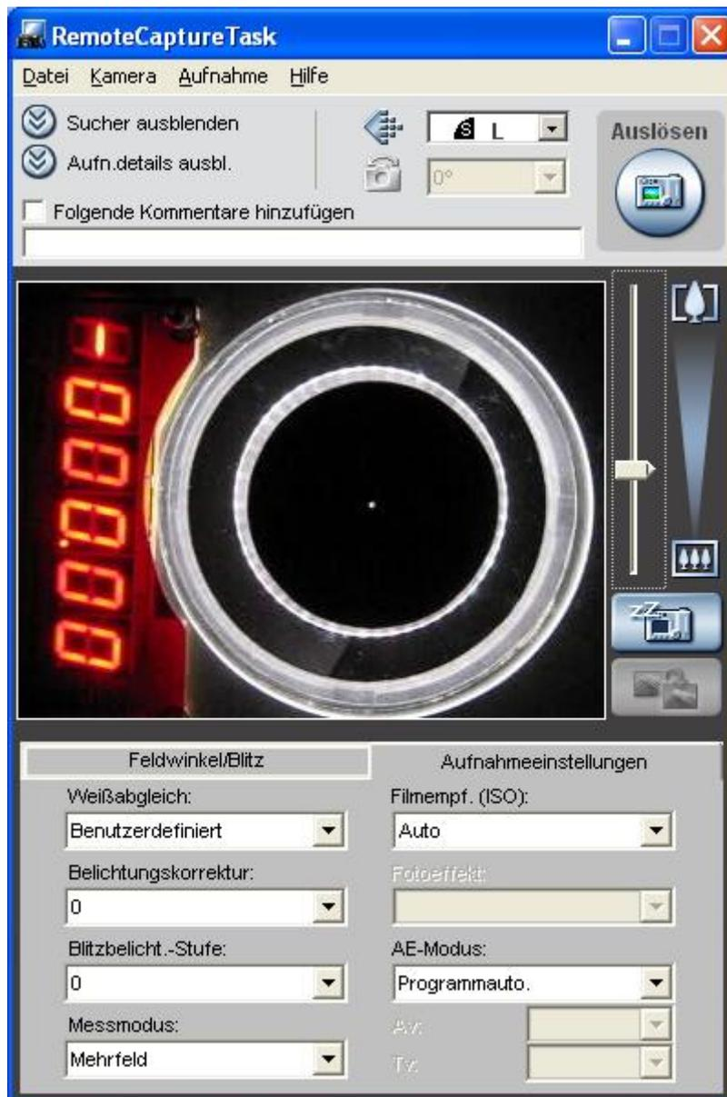
Abbildung 50) Durch Kalibrierung geladene Menü-Einstellungen 2 von 2; das fertig kalibrierte Sichtfenster zeigt hier die leere Messzelle; die Beleuchtung erfolgt hier durch den LED-Ring.
