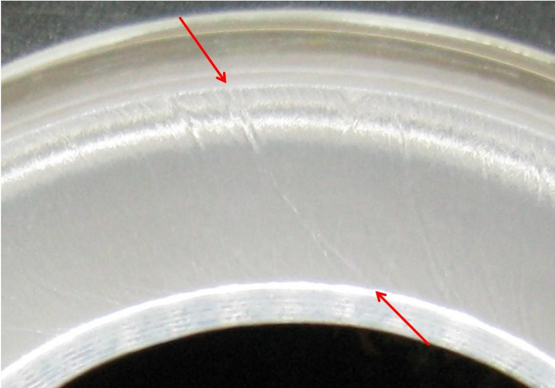
Abbildung 68) Terephthalsäuredichlorid/ $\beta$ -Casein-Membran mit einer Deformation von  $\gamma_i = 4,92\%$ ; Einsetzen der ersten scherinduzierten Falten; setzt knapp vor dem Bereich des lokalen Minimums der zweidimensionalen Moduln im in Abbildung 66 gezeigten *Strain-Sweep*-Test ein.
