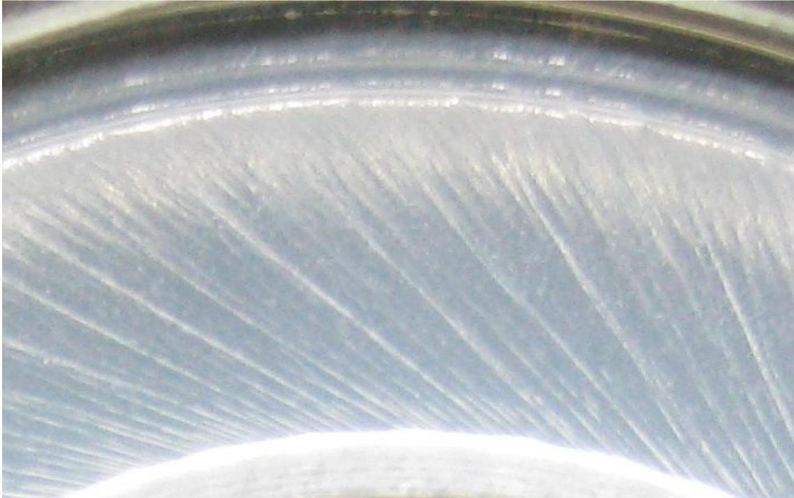
Abbildung 94) Typisches Faltenbild gegen Ende des in Abbildung 92 gezeigten Relaxationsvorgangs ( $t \approx 25$  Minuten); die Änderungen zeigen sich hauptsächlich am unteren Rand des Bildes.
