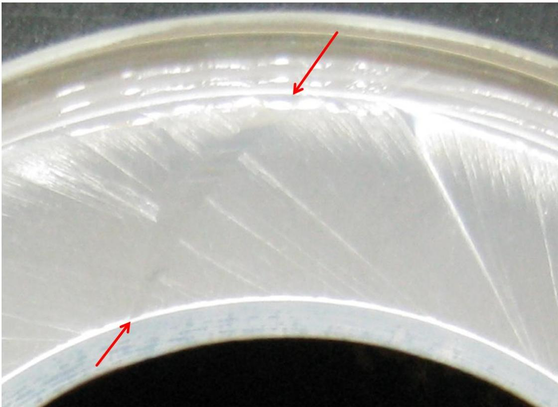
Abbildung 71) Terephthalsäuredichlorid/ $\beta$ -Casein-Membran mit einer Deformation von  $\gamma_i = 60,48\%$ ; Bildung der ersten Risse senkrecht zur Orientierung der Falten; das Reißen ist kurz nach dem Maximum des *Strain-Hardening* im *Strain-Sweep*-Experimentes beobachtbar.
