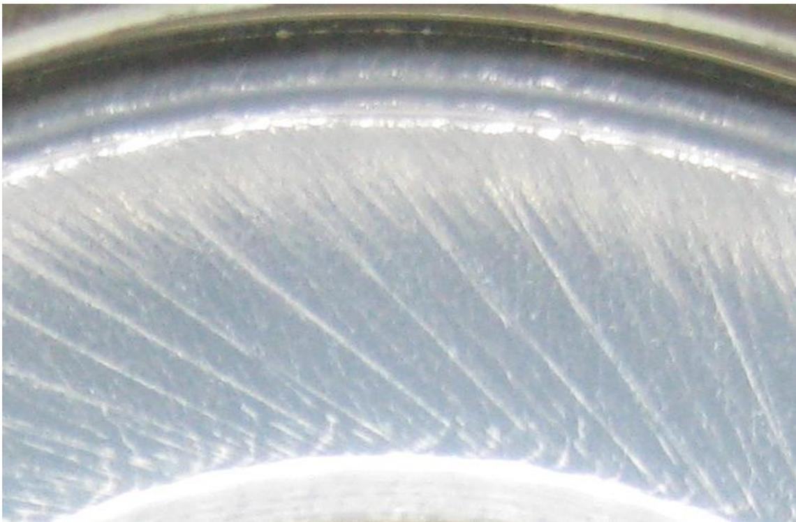
Abbildung 93) Typisches Faltenbild zu Beginn des in Abbildung 92 gezeigten Relaxationsvorgangs ( $t \approx 0$  Minuten).
