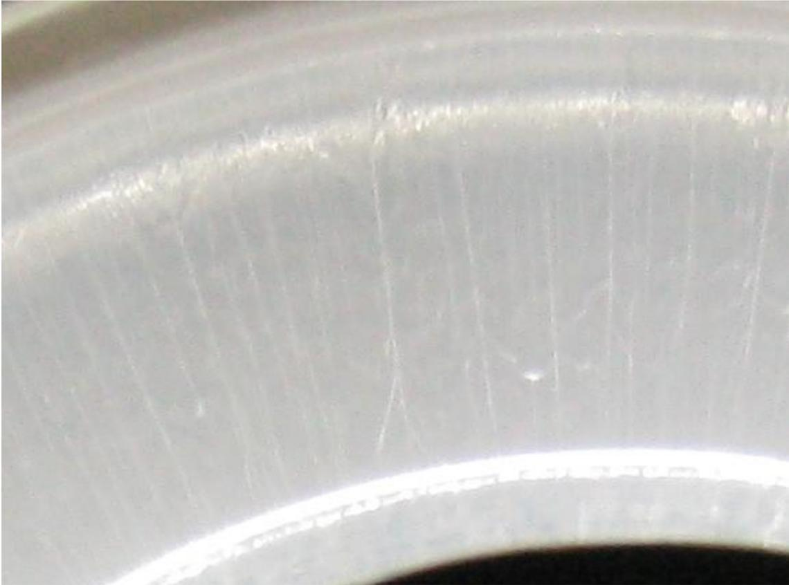
Abbildung 72) Terephthalsäuredichlorid/ $\beta$ -Casein-Membran mit *radialen Ruhefalten* (keine Deformation angelegt).
