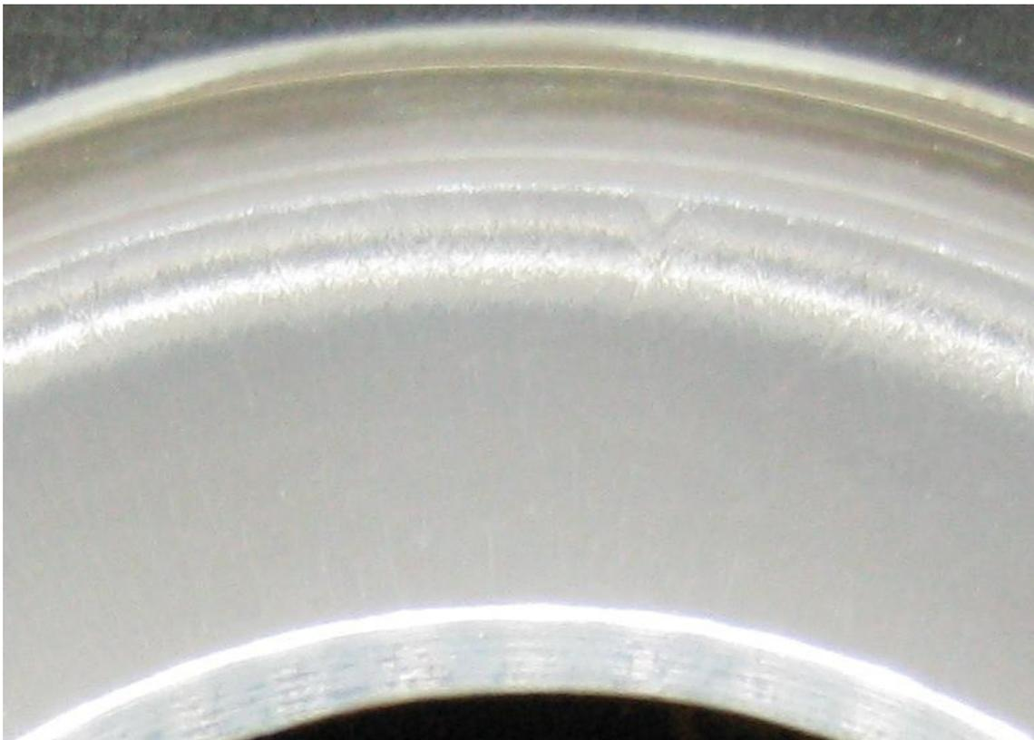
Abbildung 67) Terephthalsäuredichlorid/ $\beta$ -Casein-Membran mit der durch die *isotropen Ruhefalten* angerauten Oberfläche (keine Deformation angelegt).
