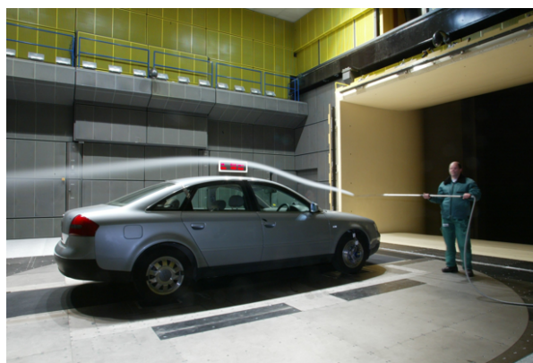
Abbildung 1: Auto im Windtunnel. Quelle: WikiCommons [58]
