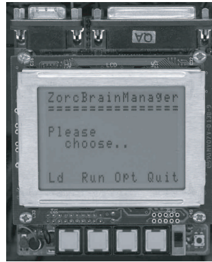
Abbildung 9.3: Der MK-4 Mikrocontroller von ZORC. Der MK-4 ist auf der Rückseite von ZORC montiert und erlaubt einen autonomen Betrieb des Roboters. Die verwendeten Batterien erlauben eine durchschnittliche Operationszeit von ca. 1h.
