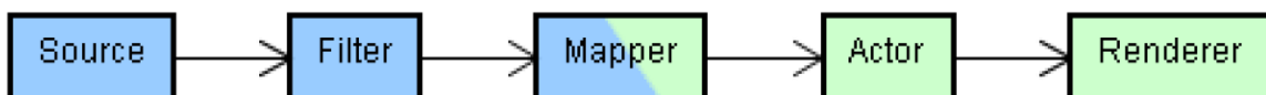
Abbildung 9.5.: Beispielhafte Darstellung des VTK-Modells mit farbigem Übergang zwischen Visualisierungspipeline und graphischem Modell
