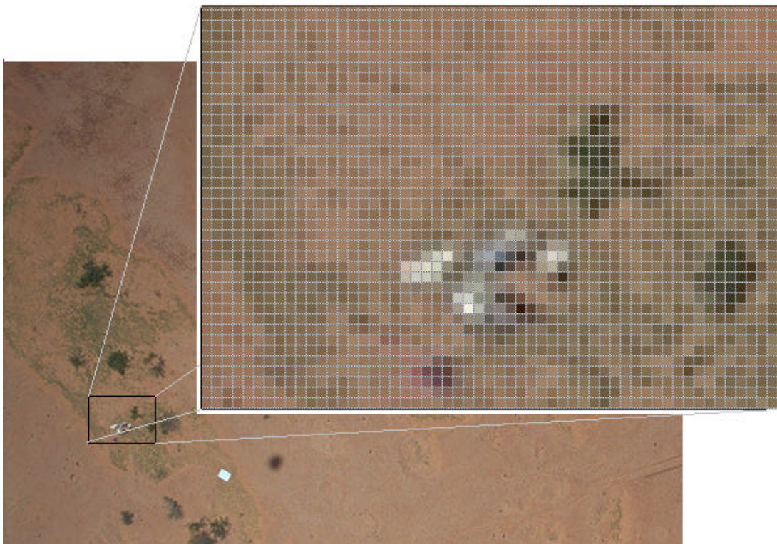
Abb. 1.1: Vergrößerung eines Ausschnitts eines typischen Bildes zur Verdeutlichung der Pixel-Darstellung des BMP-Formats
