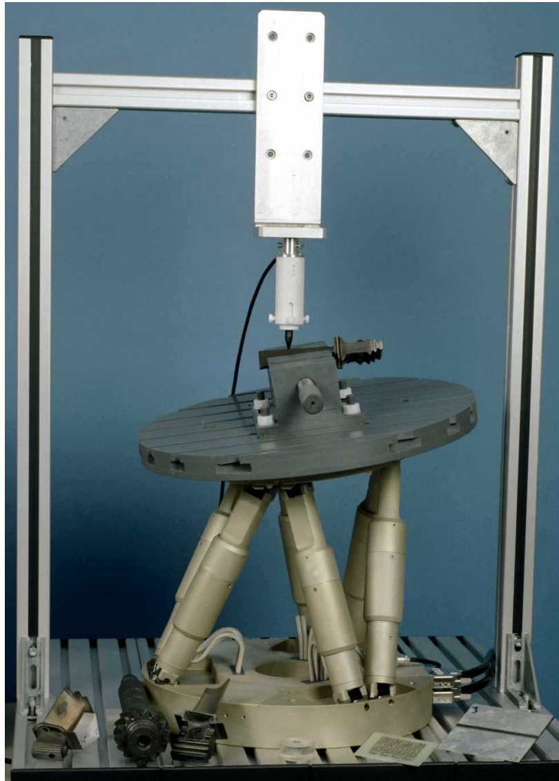
Bild 13: Zur Prüfung der Zugprobe eingesetzter Manipulator
