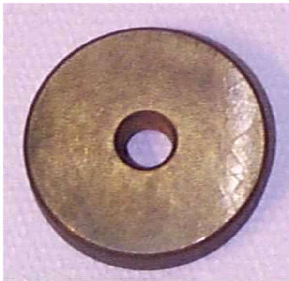
Bild 86: Testkörper Nr. 3 nach MTU (Stahlkörper mit Rissfeld)
