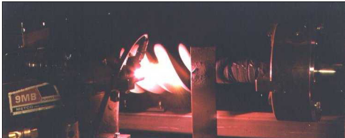
Bild 3-11: Beschichtungsvorgang der Schraubenrotoren durch Atmosphärisches Plasmaspritzen (APS)
