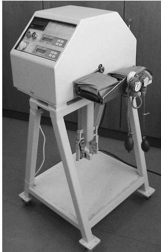
Bild 4.5 Drehmomentmessung im Handgelenk
