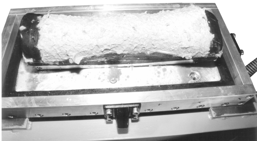
Bild 5.10 Faserformwerkzeug nach dem Anformprozess
