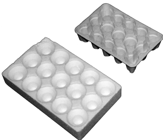
Bild 2.2: Gegenüberstellung von Verpackungsteilen aus Polystyrol (EPS) und Faserform
