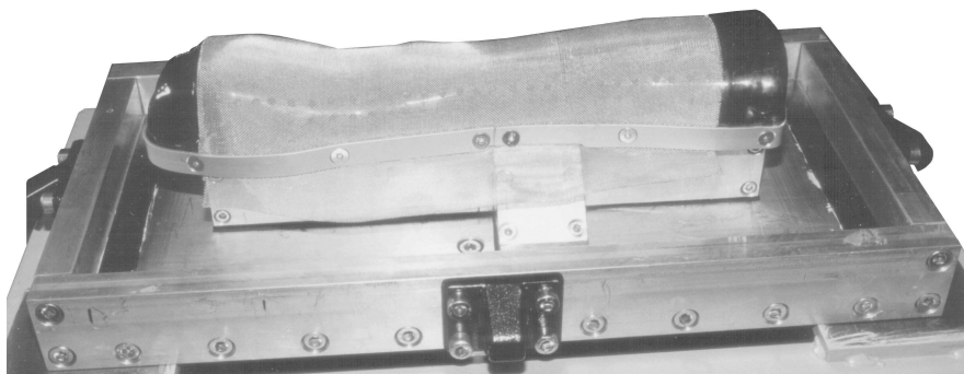
Bild 5.3 Unterkasten mit aufgesetztem Faserformwerkzeug für Unterarmorthesen
