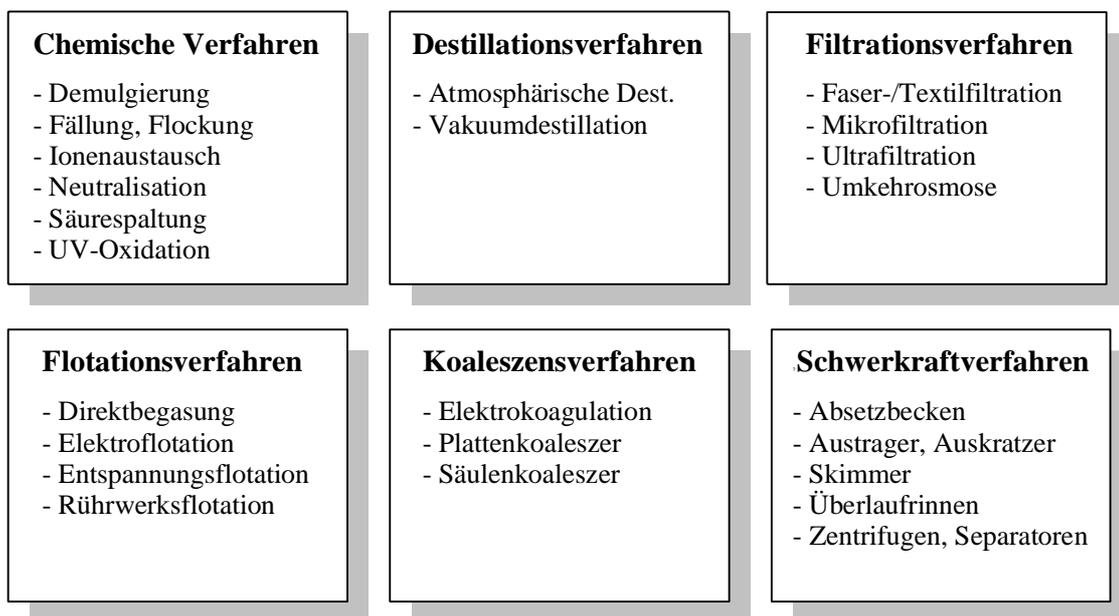
**Bild 7.10** Übersicht über die wichtigsten Verfahren der Reini- geraufbereitung
