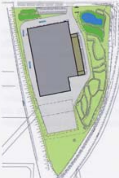
Abb. 8-1 Bei konventioneller Entwässerung über unterirdische Grundleitungen reduzieren sich die nutzbaren Bewirtschaftungsflächen auf 31%. Das Anschlussverhältnis von 9:1 lässt eine Integration in Ausgleichsflächen nicht zu.
