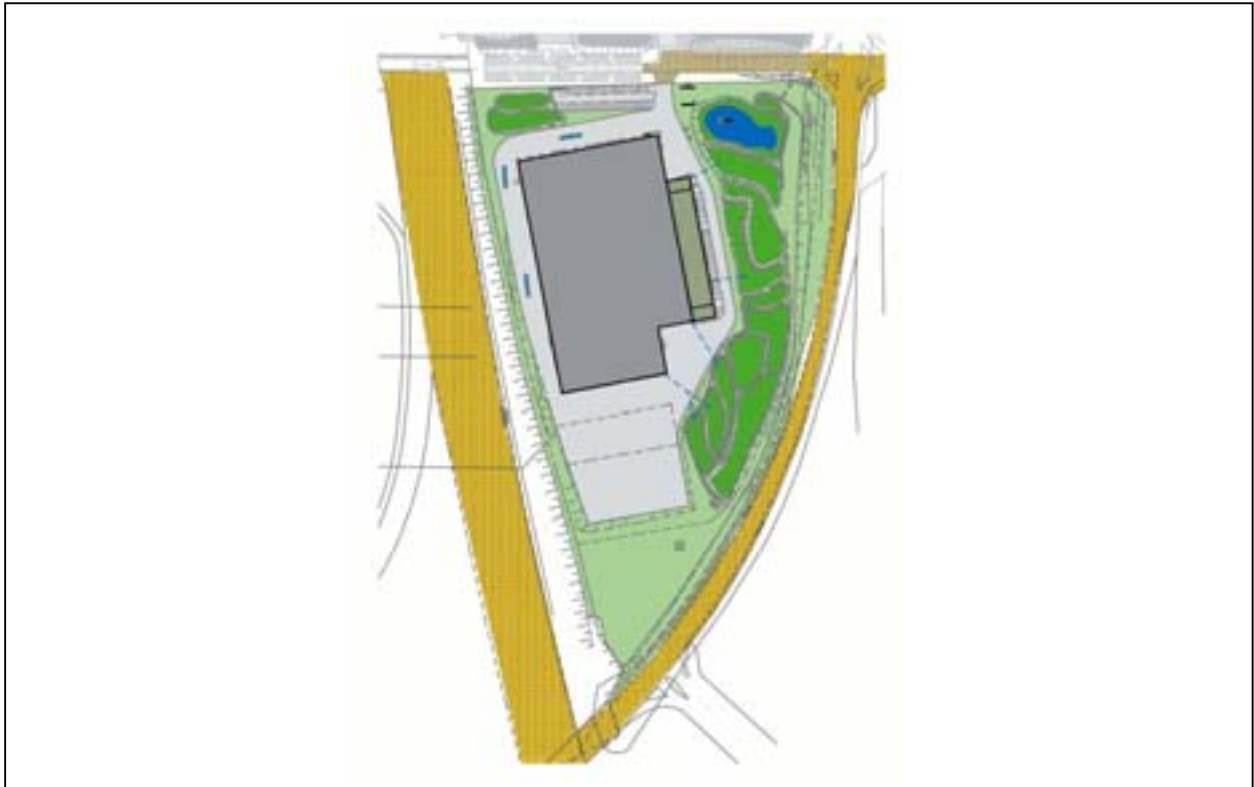
Abb. 9-1: Lageplan Modellprojekt Ardey-Quelle mit direkt angrenzenden über konventionelle Regenwasserableitung entwässerten Flächen (gelb) [eigene Darstellung]
