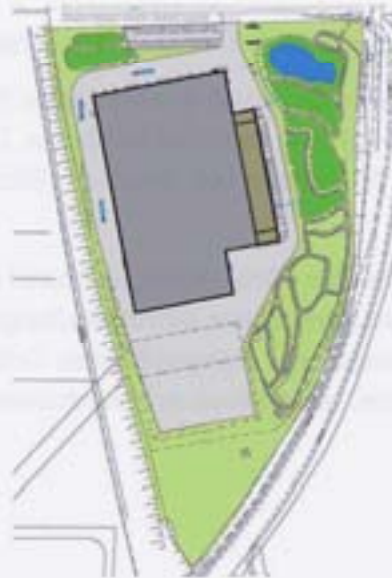
Abb. 8-2 Bei offener Ableitung über Rinnen etc. vergrößern sich die nutzbaren Bewirtschaftungsflächen auf 51%. Das Anschlussverhältnis von 6:1 lässt eine Integration in die Ausgleichsflächen nicht zu.
