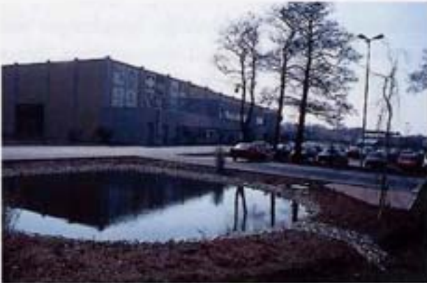
Abb. 7-36 Regenwassergespeicher Zierteich mit Überlauf in die Versickerungsmulde
