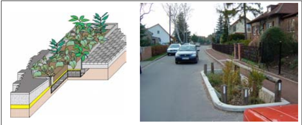
Abb. 8-17: Schema und Funktionsprinzip „InnoDrain“ [SIEKER, 2003] sowie Anwendungsbeispiel
