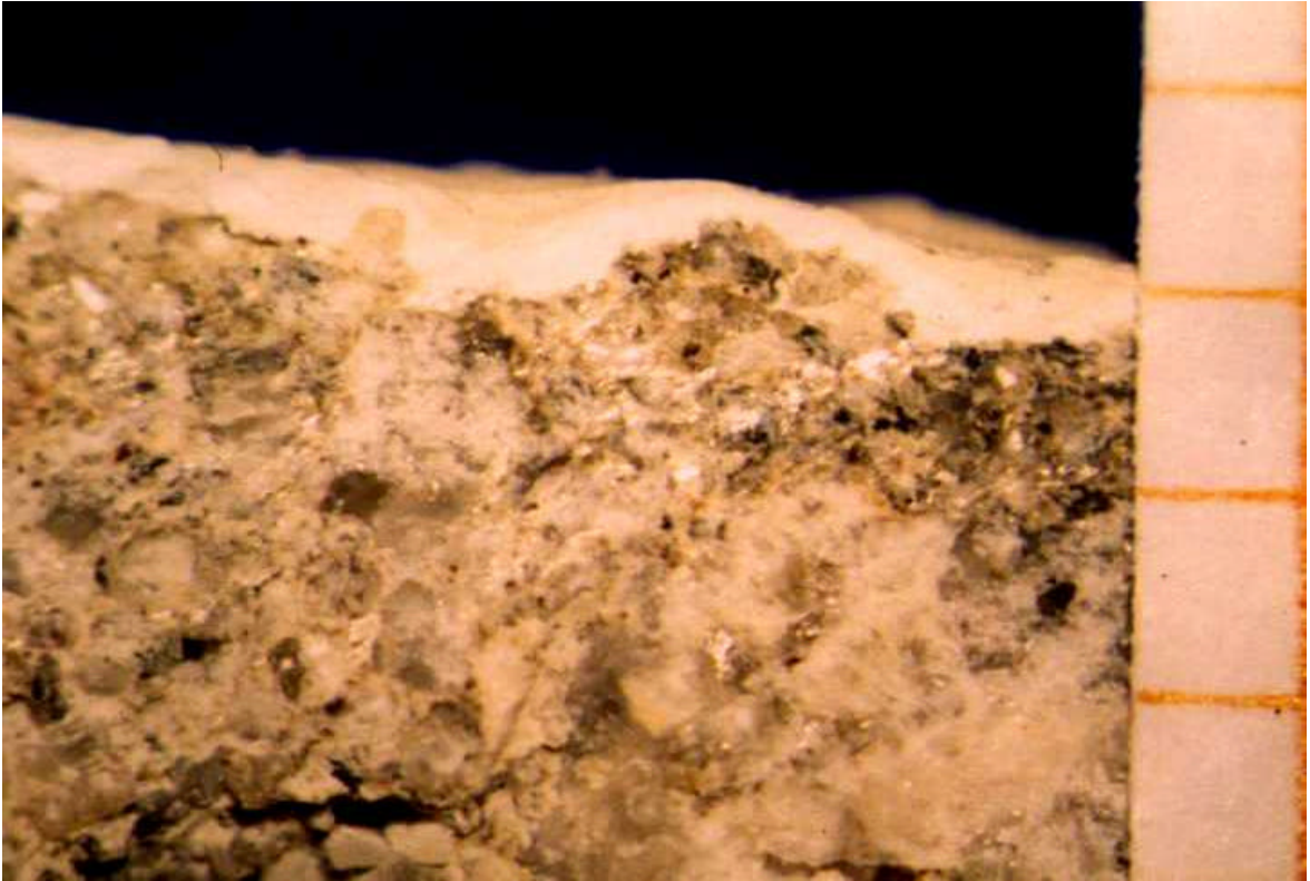
Bild 33: Rauheit A, ausgeprägt rauh, Acrylat 2x gerollt
