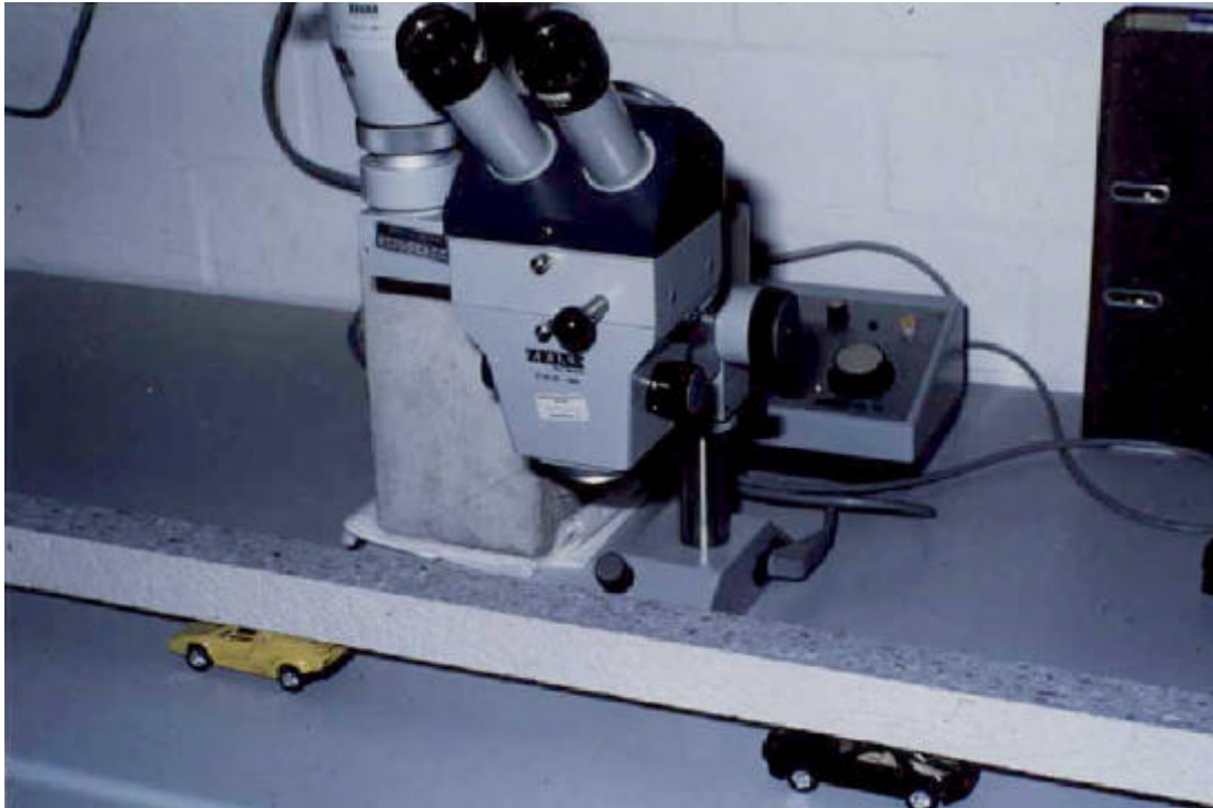
Bild 27: Schichtdickenmessung an Schnittflächen von Probekörpern unter dem Stereomikroskop
