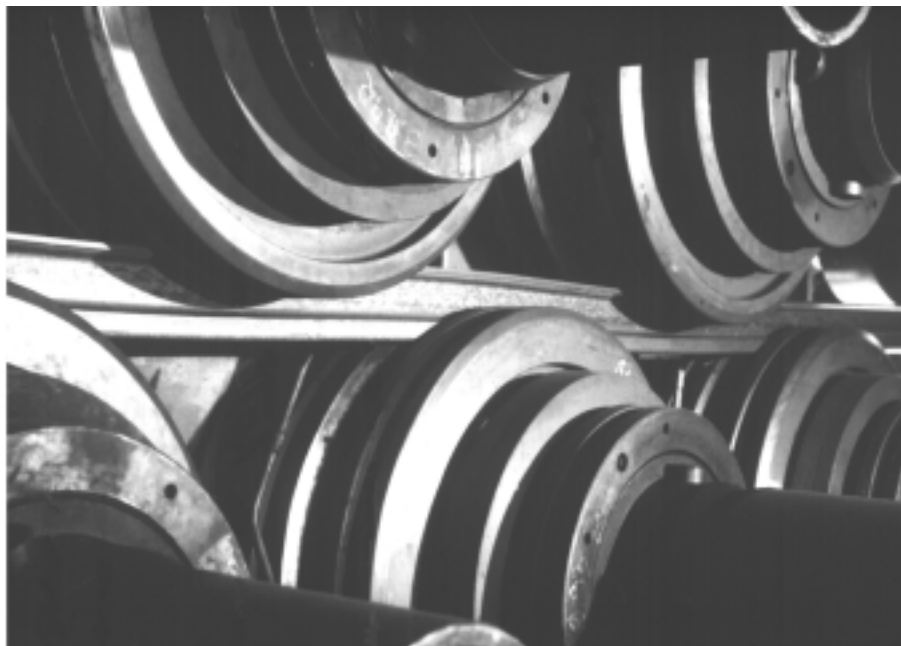
Abb. 7.9: Richtrollen und Richtgut in einer Rollenrichtmaschine
