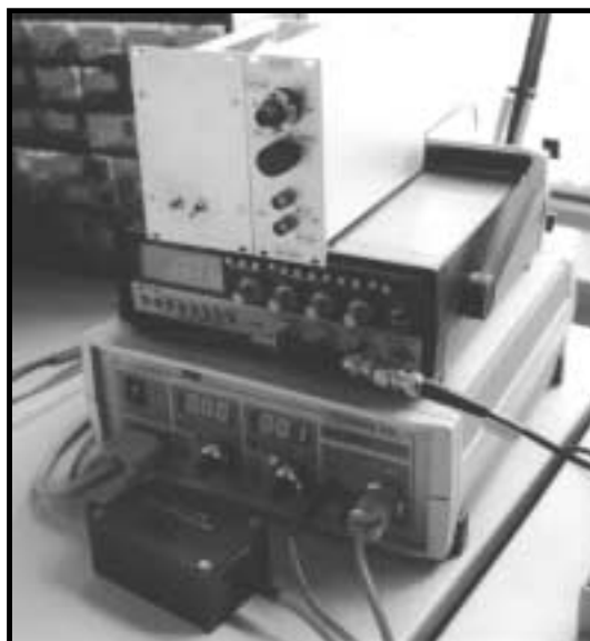
BILD 4.27: Hochspannungsquelle mit Taktgenerator u. Steuereinheit
