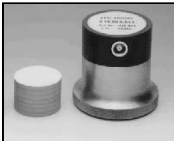
BILD 4.10: Moderner Niederfrequenzprüfkopf mit Stapeltechnik [LACH1996]
