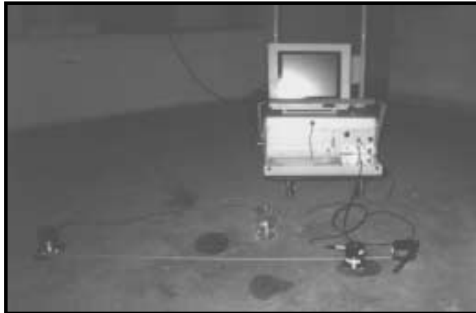
BILD 6.10: Prüfgerät bei Durchschallungsmessung
