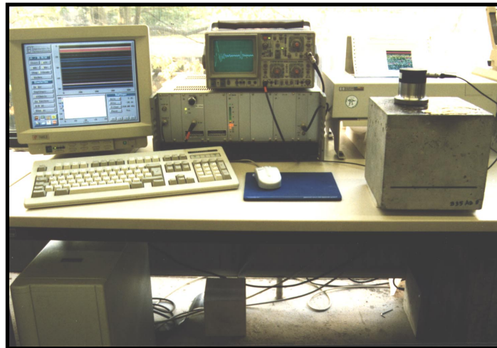
BILD 4.6: Realansicht der Prüfeinrichtung mit NFUS2000v2 und angeschlossenen PC486
