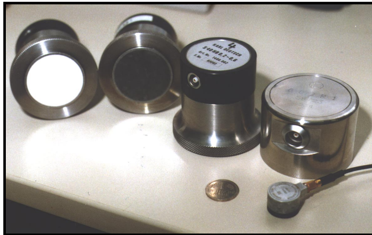
BILD 4.11: Realansicht der Prüfköpfe «1», «3», «4» und «6» (oben, s.Text) sowie Pr.k. Dungeon S9204 (u.r.)
