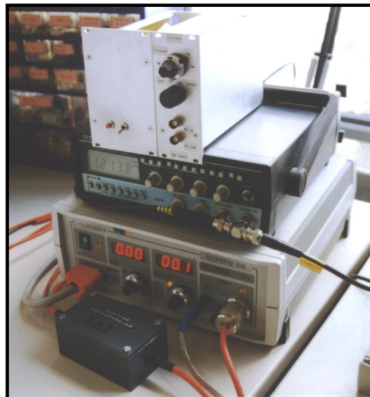
BILD 4.27: Hochspannungsquelle mit Taktgenerator u. Steuereinheit
