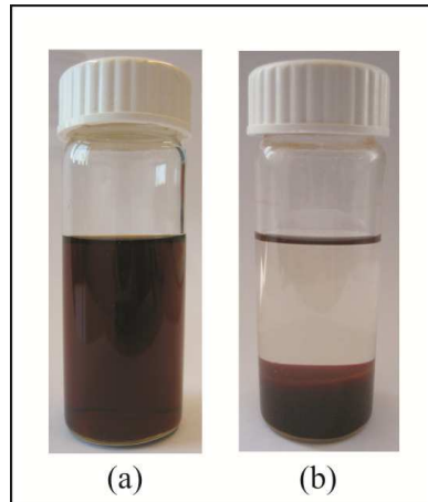
Abb. 59: Eisenoxid-Nanopartikel aus zwei inversen ME'en in einem Verhältnis von 1 zu 1 innerhalb von 5 sek. hergestellt. Die Bilder zeigen die unbeschichteten Nanopartikel (a) am Tag ihrer Herstellung und (b) nach einem Monat.
