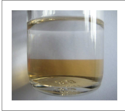
Abb. 104: Betrachtung der Kapselzerstörung durch die Bildung von zwei Phasen bei der verkapselten ME bei Verwendung des Eisensalzes \text{FeCl}_2 bzw. \text{FeCl}_3 und bei einer AOT-Konzentration von 0.07 und 0.5 M.
