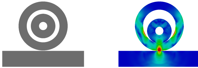
(a) Startkonfiguration von Beispiel 8 (b) Deformierter Zustand bei t = 0.24 mit von Mises Spannungen
