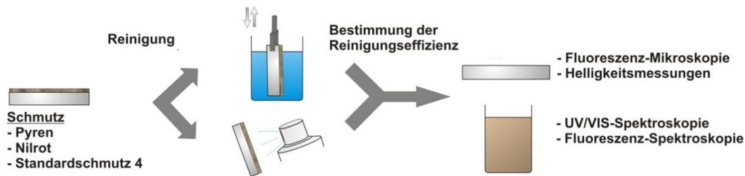
**Abb. 38 Schematische Darstellung der Reinigung superhydrophober Oberflächen und der Bestimmung der Reinigungseffizienz**
