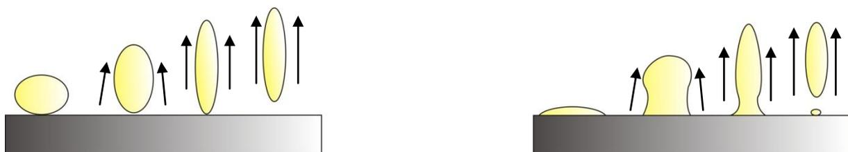
**Abb. 30 Vollständiges Entfernen des Öltropfens von der Oberfläche durch den roll-up Mechanismus bei Kontaktwinkel zwischen  $90^\circ$  und  $180^\circ$  (links) und partielle Reinigung der Oberfläche bei Kontaktwinkel  $< 90^\circ$  (rechts)**
