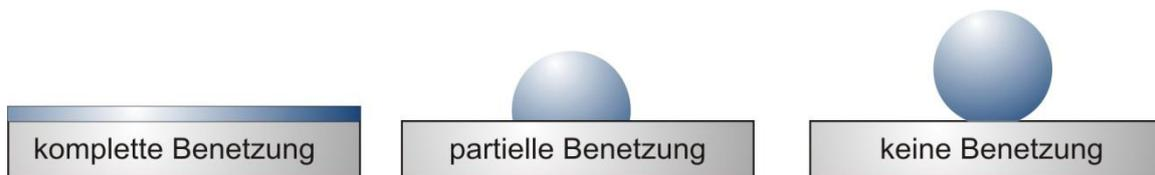
**Abb. 3 Die nach Young möglichen Benetzungszustände: komplette Benetzung  $\theta = 0^\circ$ , partielle Benetzung  $0^\circ > \theta < 180^\circ$  und keine Benetzung  $\theta = 180^\circ$**
