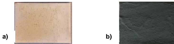
**Abb. 64 Mit Standardschmutz kontaminierte Oberflächen: a) Kontaminierung des pulverförmigen Standardschmutzes erfolgte in der Kontaminationskammer nach <sup>[144]</sup>, b) Applikation des Testschmutzes durch verdünnen mit Ethanol und vorsichtiges Verstreichen mit einem Spatel**
