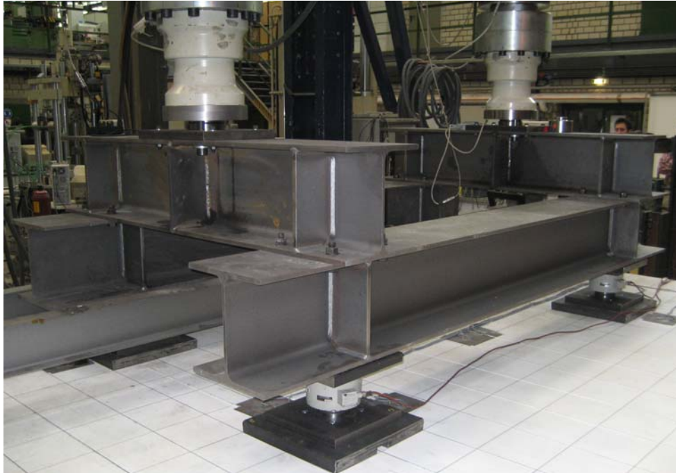
Bild 6.10: Versuchsaufbau für Tandemlasten
