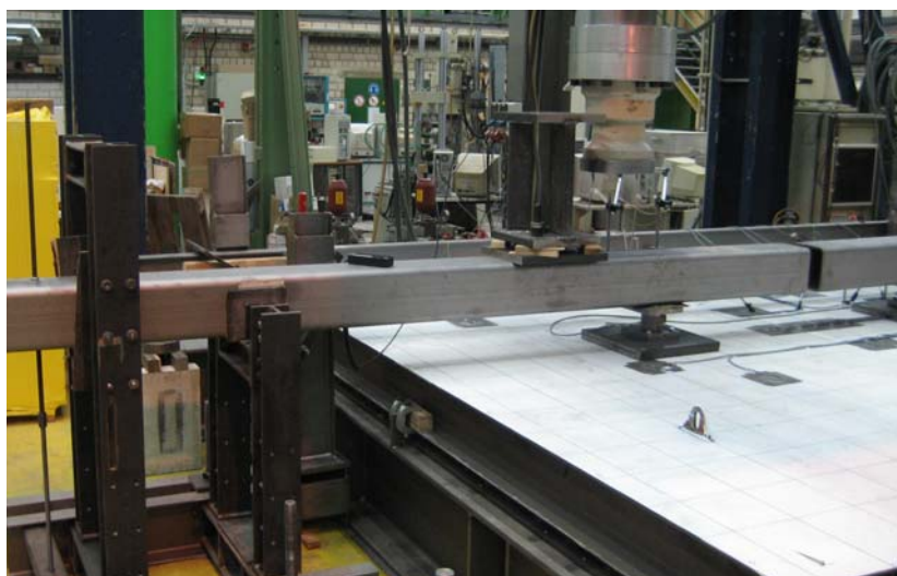
Bild 6.8: Versuchsaufbau für Einzelradlasten
