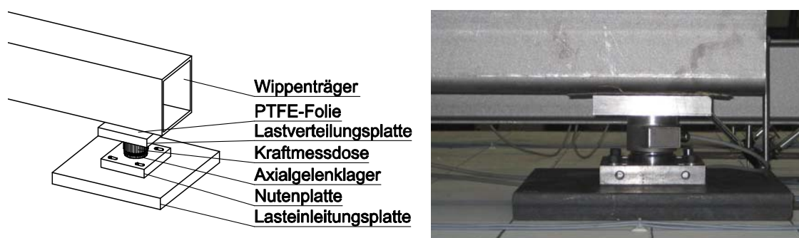
Bild 6.7: Lasteinleitung/Messpaket unterhalb des Wippenträgers
