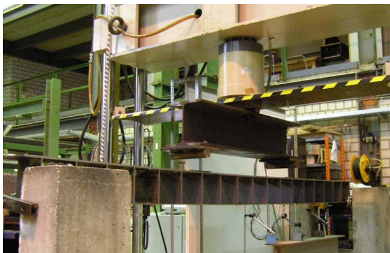
Bild 3.5: Übersicht des Versuchsaufbaus für die Plattenstreifenversuche
