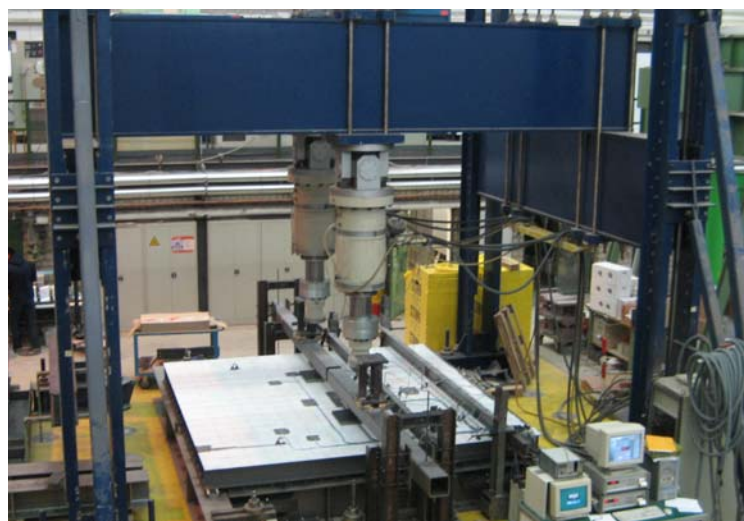
Bild 6.2: Prüfgerüst mit 2 x 1,6 MN Prüfzylindern, Institut für Bauforschung TU Dortmund
