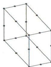
Bild 3-2: Volumenelement Typ C3D20 mit 20 Knoten und quadratischem Polynomansatz
