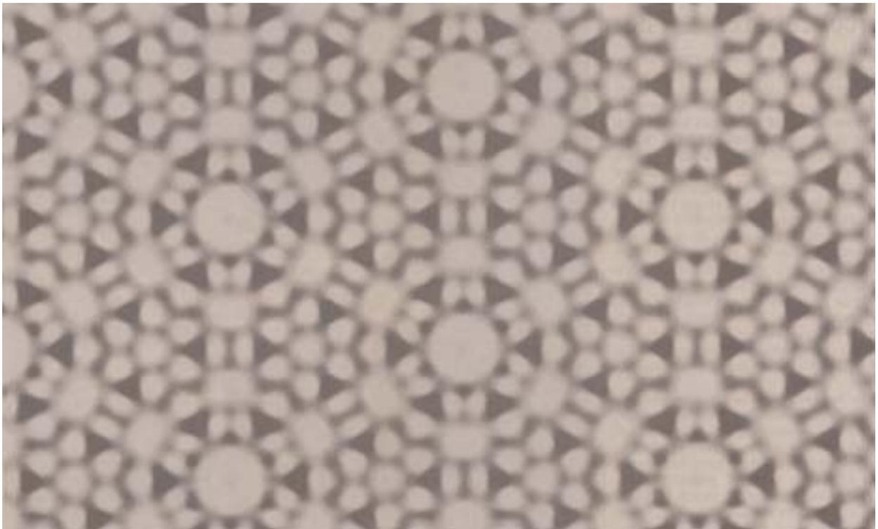
Abb. 46: „Dieses molekulare Blumenband entsteht spontan, wenn Nickel-Komplexe von Cyclam und Benzoltricarbonsäure in Wasser zusammengebracht werden. Die aus jeweils sechs Nickelkomplexen und sechs Säuremolekülen zusammengesetzten und durch Wasserstoffbrücken zusammengehaltenen Ringe bilden ein dreidimensionales Netz.“
