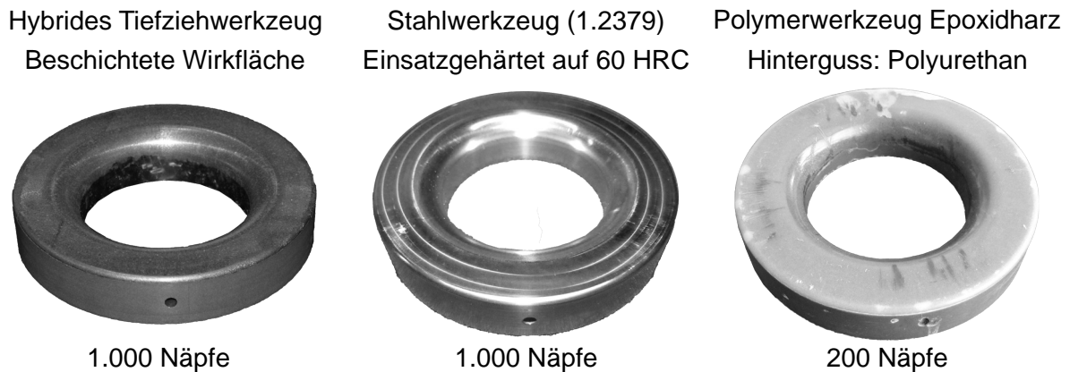
Abbildung 7.17: Matrizen nach 1 000 bzw. 200 gezogenen Nöpfen aus HC380LA
