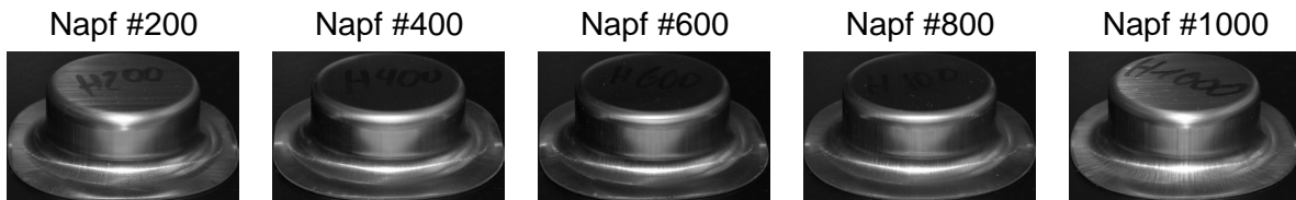
Abbildung 7.20: Mit hybridem Tiefziehwerkzeug umgeformte Näpfe aus HC380LA zu verschiedenen Zeitpunkten
