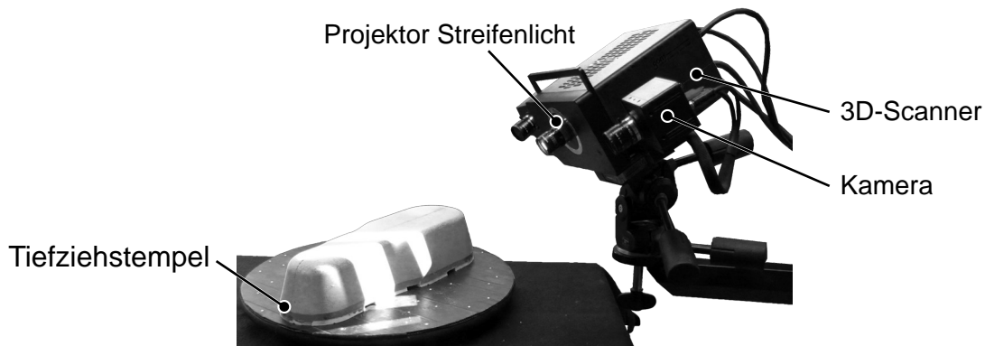
Abbildung 5.35: Aufbau zur Messung der Fertigungsgenauigkeit indirekt gespritzter Wirkflächen
