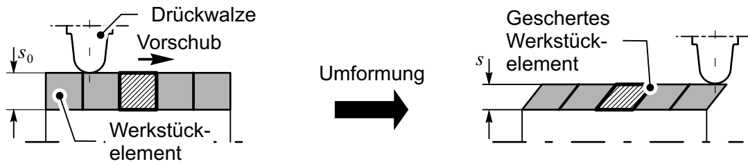
Abbildung 2.5: Scherung des Werkstoffes über der Blechdicke beim Drückwalzen nach [39]
