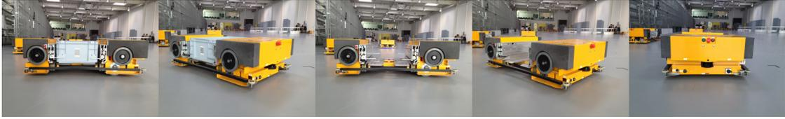
Abbildung 9.7.: Die Abbildung zeigt die im Rahmen der Evaluation der Cluster-Splitrate und Klassifikationsrate verwendeten Fahrzeugposen mit und ohne Beladung. Von links nach rechts: Fahrzeug von der Seite mit Kiste, schräg mit Kiste, von der Seite ohne Kiste, schräg ohne Kiste und frontal.
