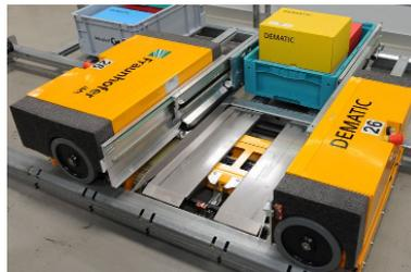
Abbildung 2.2.: Das Multishuttle Move nimmt mit seinem Teleskoparm einen Kleinteileladungsträger auf (Quelle: Fraunhofer IML)
