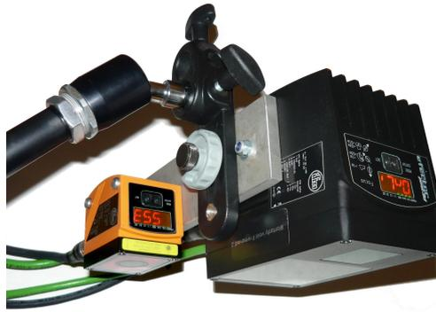
Abbildung 2.4.: Die Abbildung zeigt zwei an einem Stativ befestigte PMD-Kameras. Die linke PMD-Kamera, ein Vorserienmuster, (● oranges Kameragehäuse) entspricht dem Typ O3D100AA. Die rechte PMD-Kamera (● schwarzes Kameragehäuse) des Typs O3D201AB stellt ein verbessertes Nachfolgermodell der O3D100AA dar. (Quelle: Fraunhofer IML)
