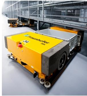
Abbildung 2.1.: Multishuttle Move bei der Regalausfahrt (Quelle: Fraunhofer IML)
