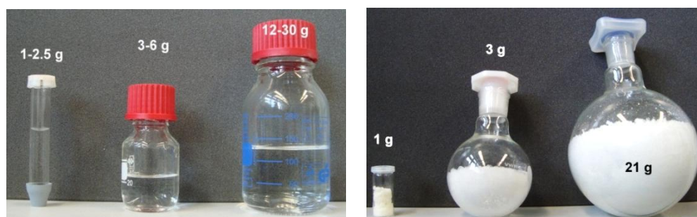
Abb.3.10: Scale-up der eingesetzten Glasgefäße für die MW-Synthese (10-250 mL, links) und die daraus gewonnenen Produktchargen an DDA-PMOX (1-21 g, rechts).
