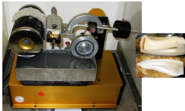
Abb.5.1: Wassergekühlte 0.3 mm-Drahtsäge zum Schnitt von Rinderdentinscheiben.
